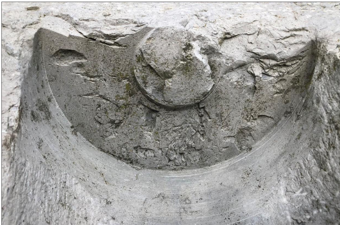
Fig. 20. Intensieve slijtagesporen van het glijlager. Grootste diameter: 20,5 cm. Foto's: Alfons Bruekers.
