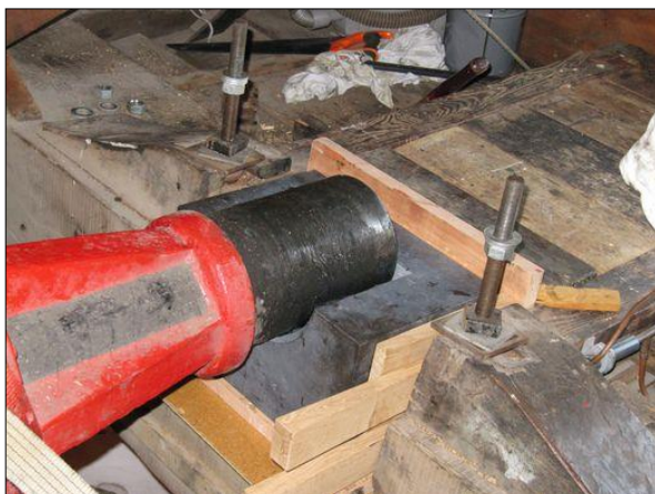
Fig. 19 en 20. Moderne broeksteen van windmolen Windlust in Wateringen met daarin de gietijzeren 'muts' van de wiekenas. Foto's: www.westlandsemolens.nl .
