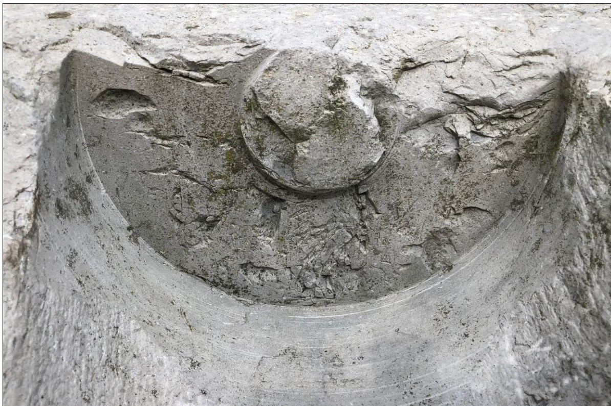
Fig. 23. Intensieve slijtagesporen van het glijlager. Grootste diameter: 20,5 cm. Foto's: Alfons Bruekers.
