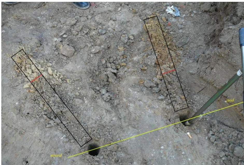
Figuur 13. Vulling van boorkernen Edelmanboring langs noord-zuid-as laat richting noorden een aflopende diepte van de trechterinsteek zien.
