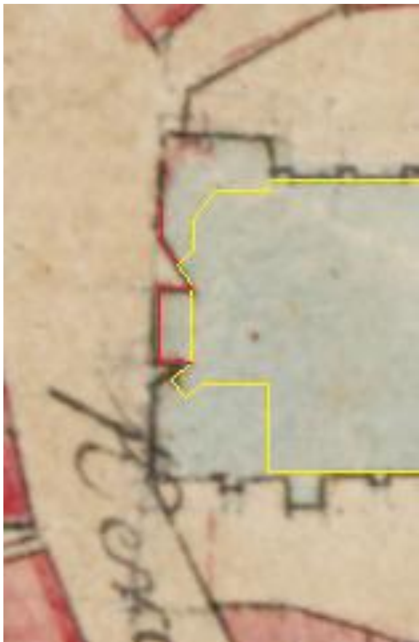
Figuur 55. De ondergrondtekening is het kadastrale minuutplan van 1844. De gele lijn is de contour van de kerk in 2014. In rood de bij het onderzoek teruggevonden muurresten van aanbouwen aan de kerktoren.
