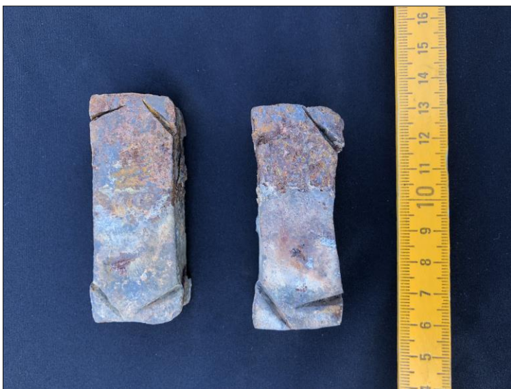
Fig. 7. Twee smeedijzeren doken na hun verwijdering uit de onderkant van het beeld. Foto: Alfons Bruekers.
